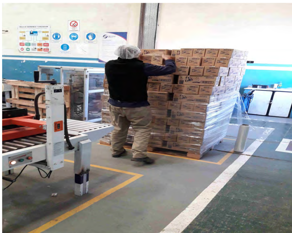
Fig. 22 – Operario realizando la estibación de las cajas de espirales.
