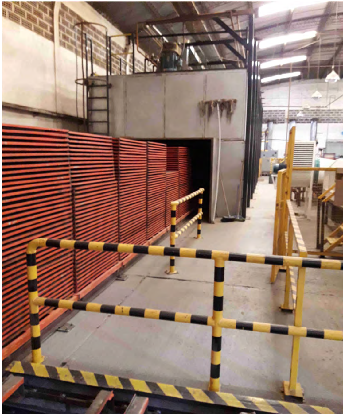
Fig. 13 - Salida de bandeja con espirales por horno de secado.
