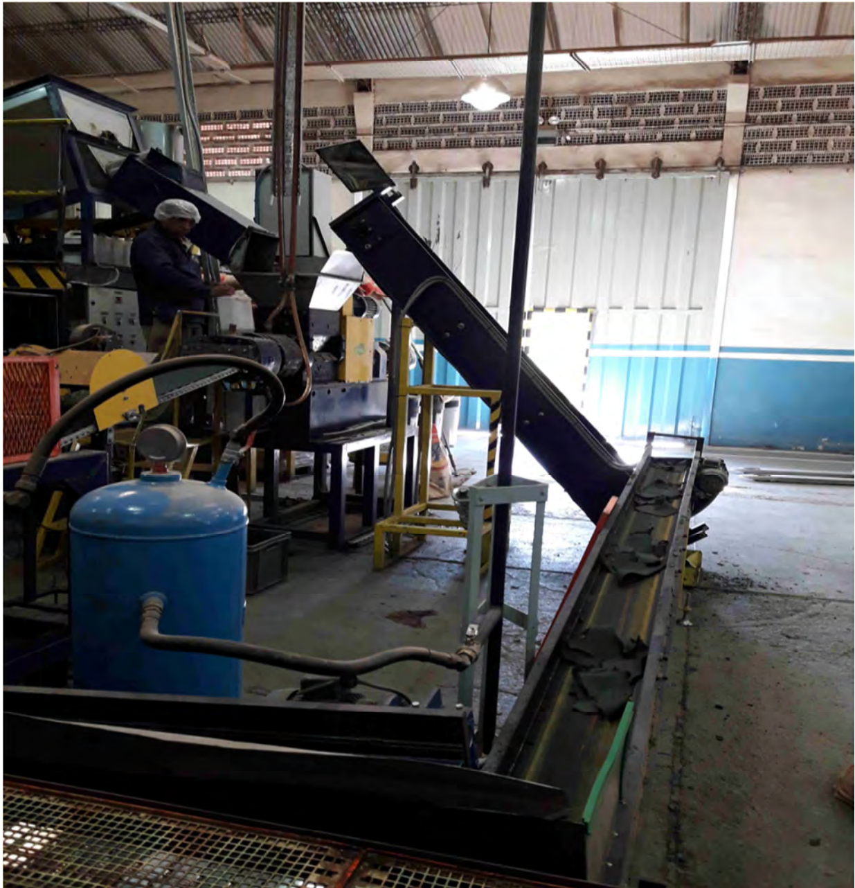
Fig. 9 – Extrusora / Operario lubricando la masa con ansol.
