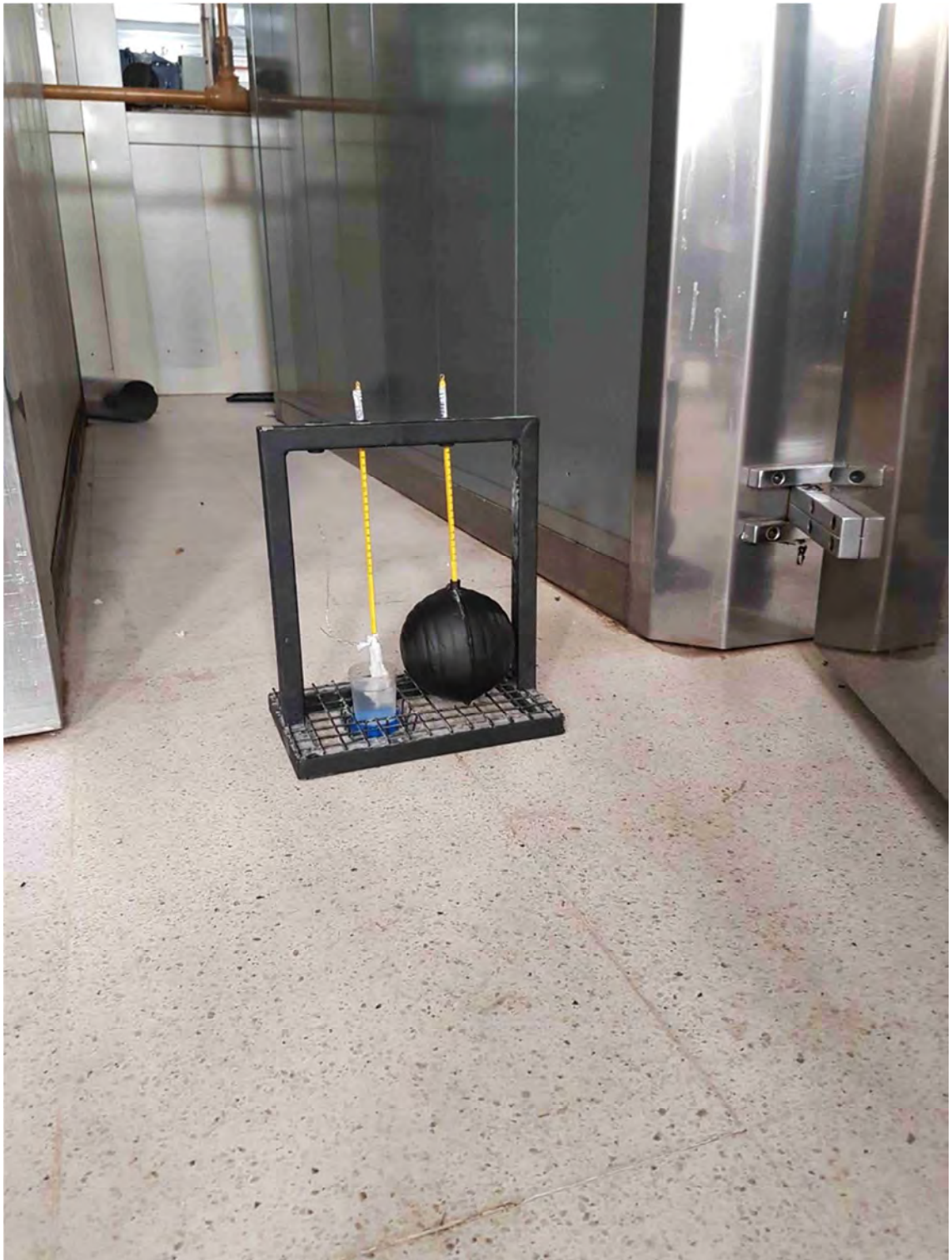
Figura 13 Medidor de Carga térmica junto a hornos
