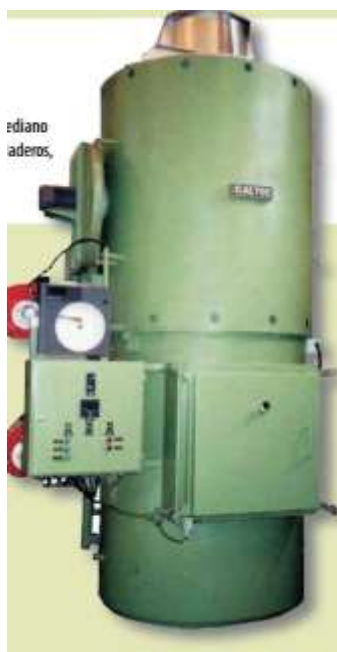
Figura 18. Imagen del horno de pirólisis de plástico (CALTEC, 2020).
