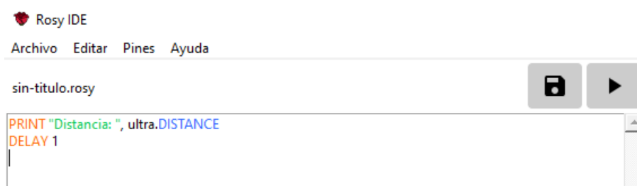
Ilustración 55: Código en Rosy para obtener la distancia mediante el uso de un sensor ultrasónico
