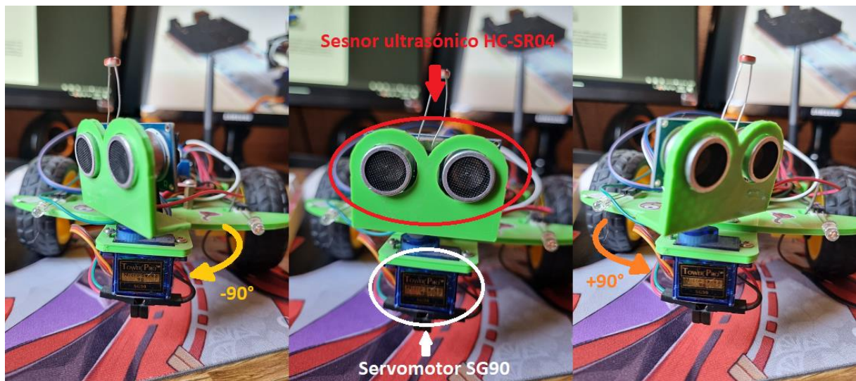
Ilustración 14: Robot Arduino con sensor ultrasónico acoplado a un servomotor [Autor de fotografía Macoritto Torcivia, 2022]
