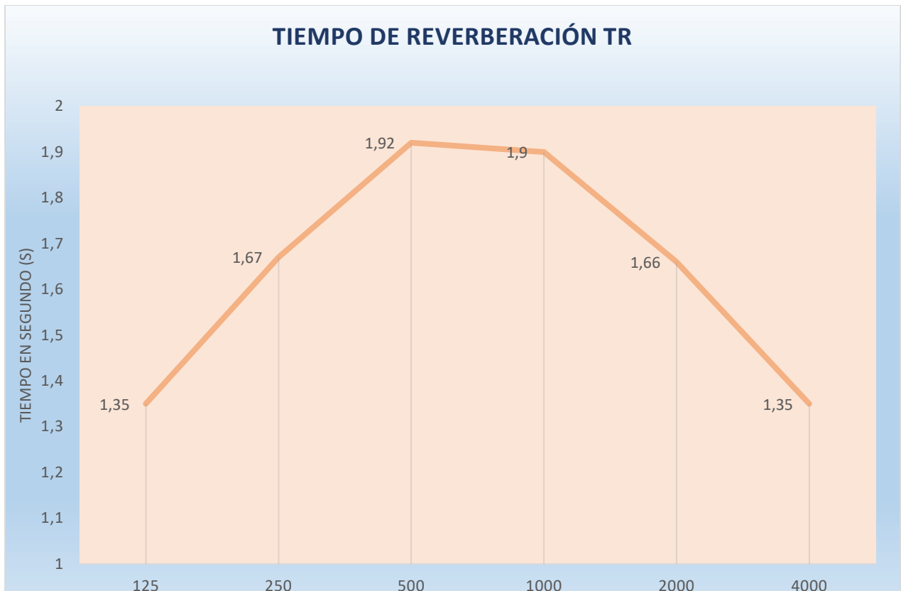
Fig. 22. Curva de las 6 mediciones del Tiempo de Reverberación
