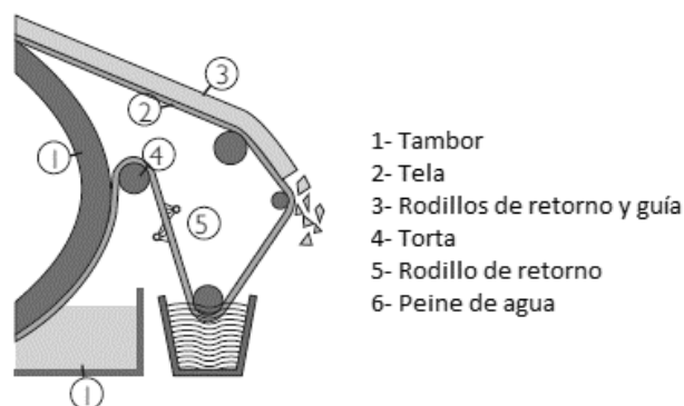
Ilustración 33. Ejemplo de sistema de descarga de torta de un filtro rotativo de vacío. Imagen extraída de [8].
