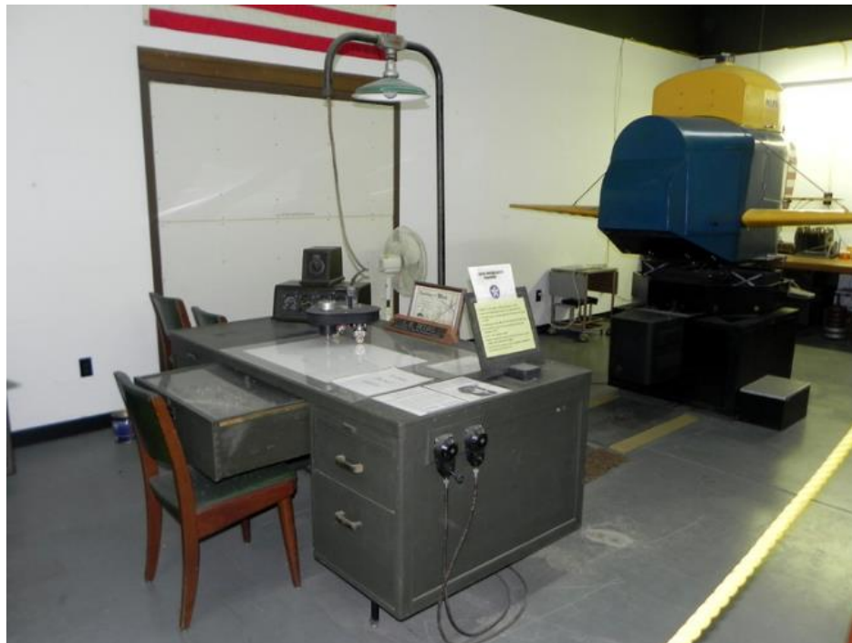
Ilustración 1. Primer simulador vuelo, “Blue Box”. Fuente: https://interestingengineering.com/ .
