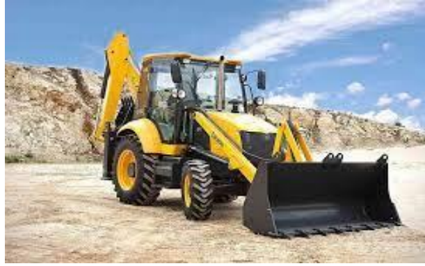
Ilustración 11. Retroexcavadora. Fuente: CAT.
