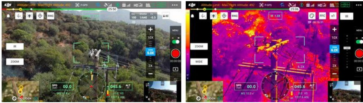
Ilustración 32: Imágenes de un poste de electricidad capturada con un sistema de 2 (dos) cámaras
