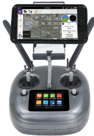
Ilustración 18: Sistema de radio de 8 km del Foxtech Cygnus-120
