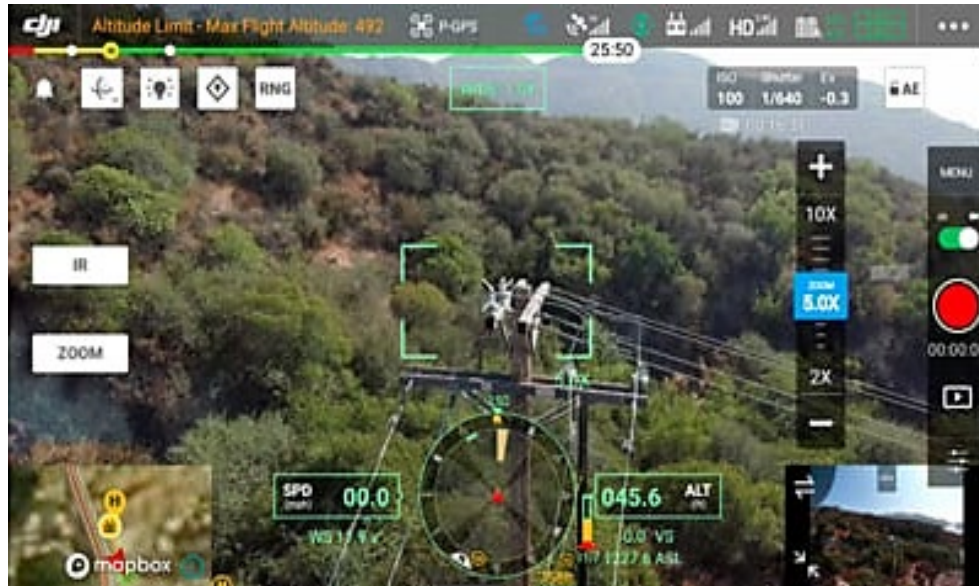
Ilustración 30: Visualización de visión de cámara normal con reconocimiento de objetos
