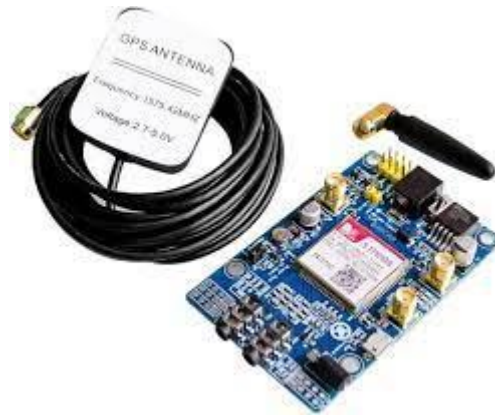
Figura 5 Placa HW-598 (Sim 808)
