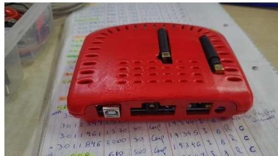
Figura 25 Carcasa superior pintada montada
