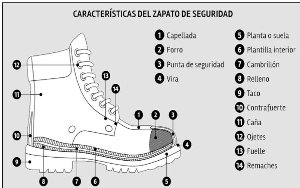
Imagen 48: Zapato de seguridad y sus elementos principales.
