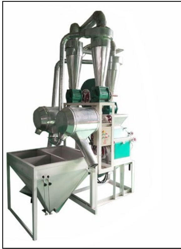
Imagen 38: Electric trigo, Pequeño Molino de rodillos.
