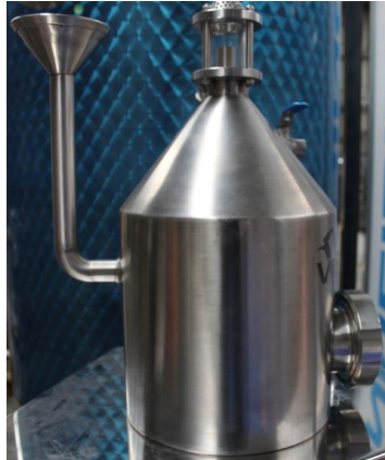
Ilustración 37. Alambique de acero inoxidable
