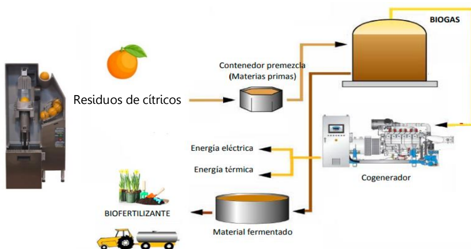
Gráfico 5 - Proceso de Producción de electricidad y biofertilizantes
