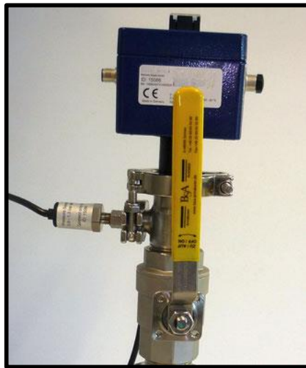
Figura 22 - Sensor de CH 4 proporcionado por Aqualimpia
