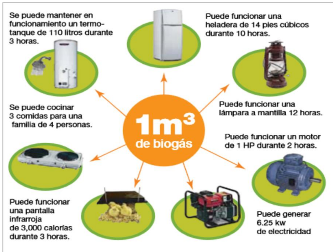
Figura 4 - Usos del biogás.
