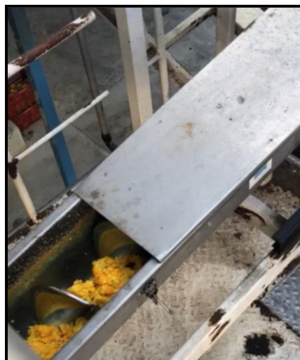
Figura 14 - Tornillo sinfin de la fábrica de jugos de Ledesma trasportando residuos cítricos
