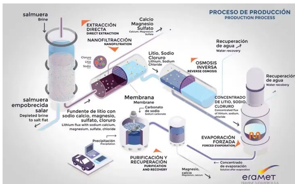
Figura 9. Proceso de extracción del litio con método DEL.
