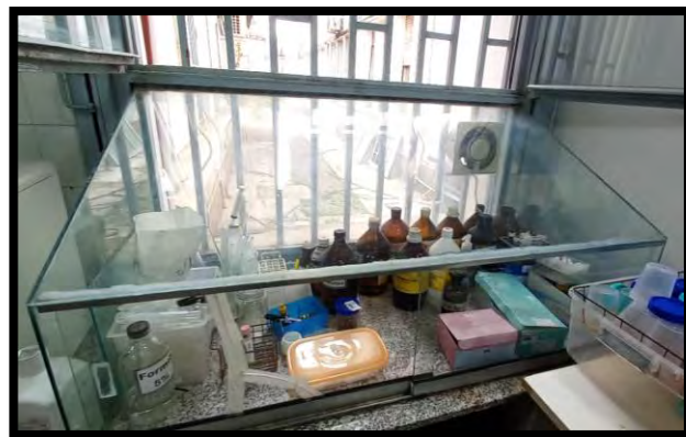
Fig. 5.34 Cabina con extracción de aire donde se almacenan sustancias en uso.
