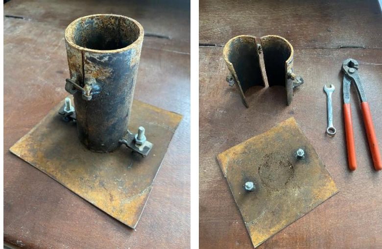
Imagen 12. Moldes de probetas.
