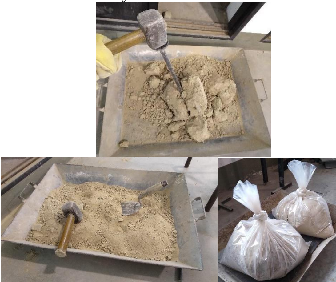
Imagen 13. Demolición de ladrillos de adobe.
