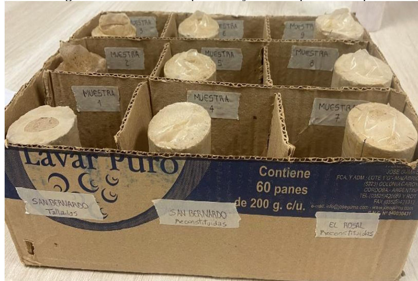
Imagen 19. Probetas listas para ensayo de compresión simple.
