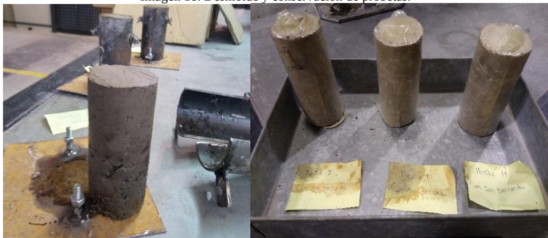
Imagen 18. Desmolde y conservación de probetas.
