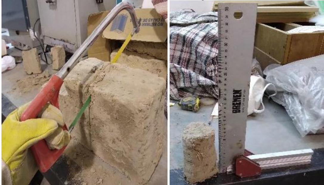
Imagen 10. Proceso de tallado de probetas.
