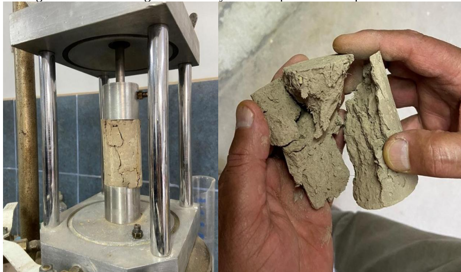
Imagen 24. Probetas luego de los ensayos de compresión en empresa Tecnosuelo.
