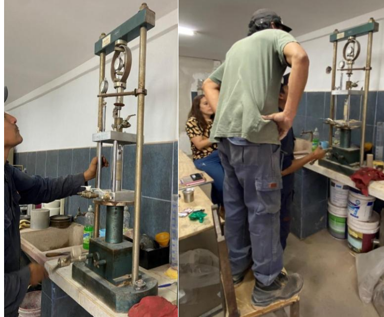
Imagen 22. Ejecución de ensayos de compresión en empresa Tecnosuelo.
