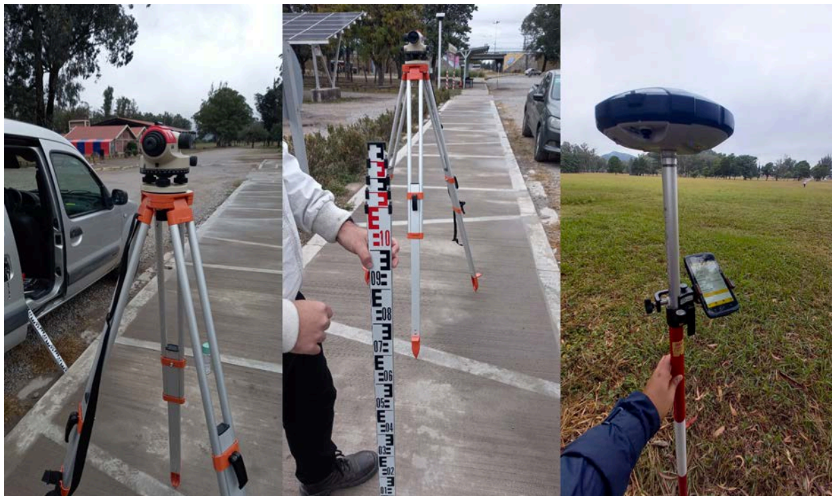
Fig. 54: Instrumentos utilizados para realizar las mediciones topográficas para obtener las secciones transversales.
