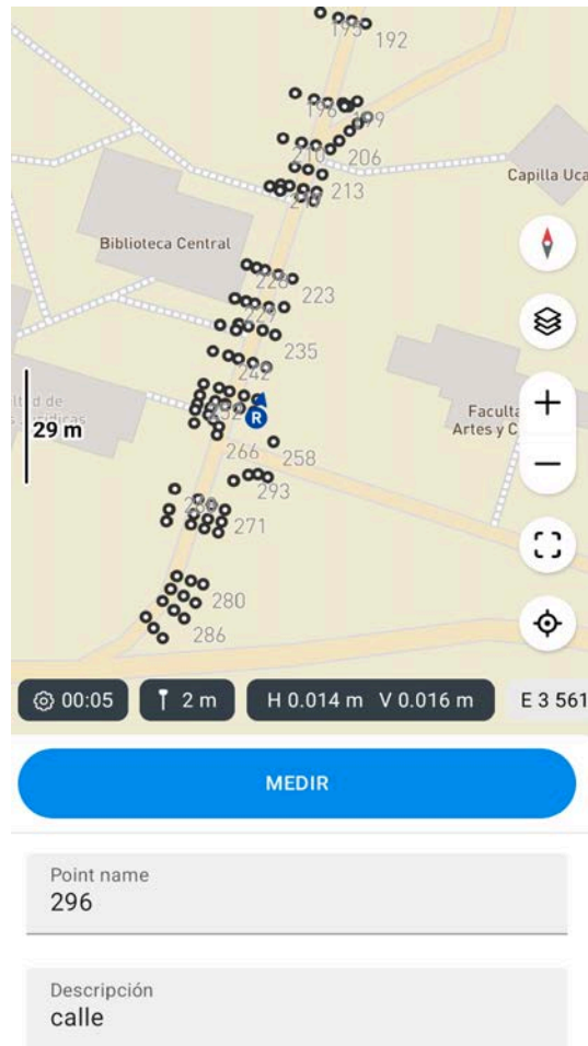
Fig. 64: Captura de imagen de la aplicación Emlid Flow del proceso de toma de la nube de puntos.
