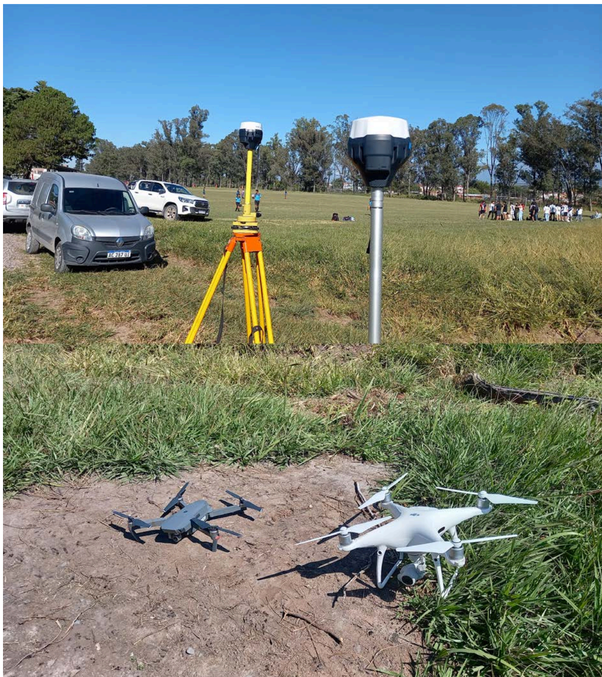
Fig. 59: Equipos utilizados para la medición topográfica por medio de drones.
