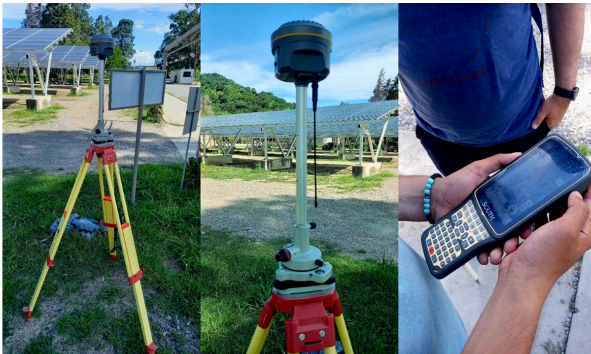
Fig. 57: Accesorios del Instrumento de medición topográfico: controladora, rover y base.
