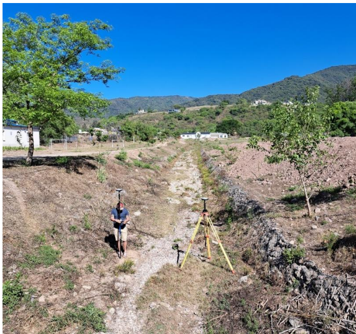
Ilustración 17 – Relevamiento topográfico con GPS
