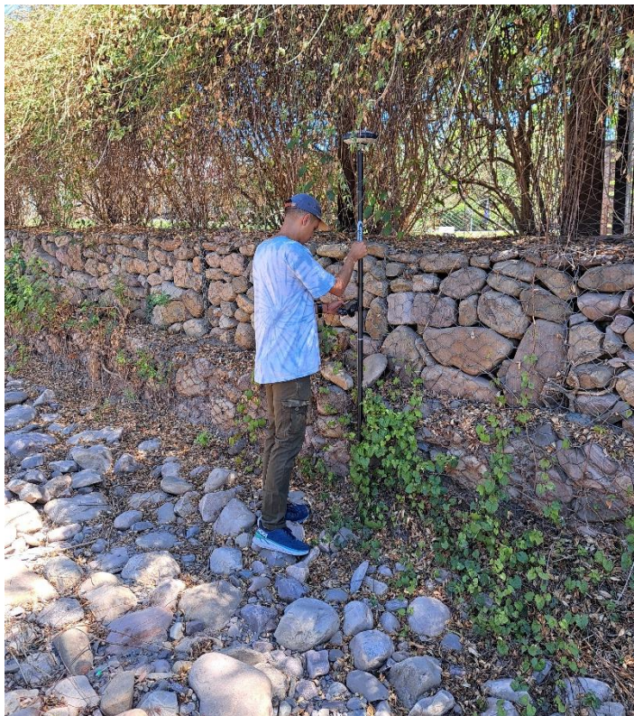
Ilustración 18 – Relevamiento topográfico con GPS
