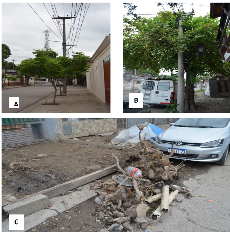
Figura 48. A, B y C. Cableado aéreo compartiendo poste: alumbrado público, servicios de TV por cable, internet, telefonía y energía eléctrica. C. Restos de un árbol extraído de una vereda por interferencia con el desagüe pluvial de la vivienda.
