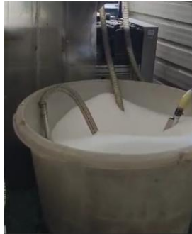
Ilustración 30: Recipiente para succión de plástico. Fuente: Shangai Doan Machinery Technology
