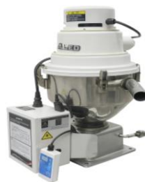
Ilustración 28: Tolva de cargador automático Fuente: Shanghai Doan Machinery Technology
