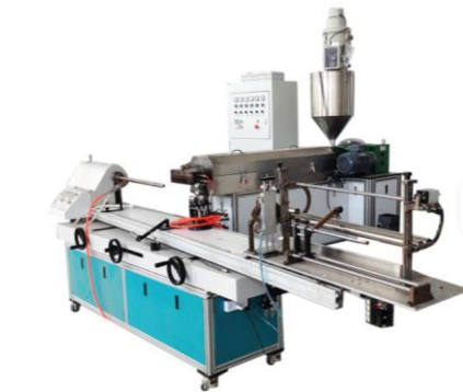
Ilustración 40: Línea de fabricación de filtros de sedimentos PP. Fuente: Wuxi Ange
