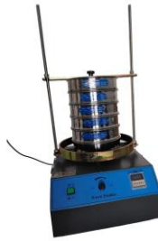
Ilustración 45: Tamizador vibratorio. Fuente: Sieve Shaker
