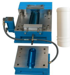
Ilustración 37: Molde de cartucho de CAG. Fuente: Taizhou Huangyan Mould
