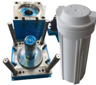
Ilustración 36: Molde de carcasa portafiltro. Fuente: Taizhou Huangyan Mould
