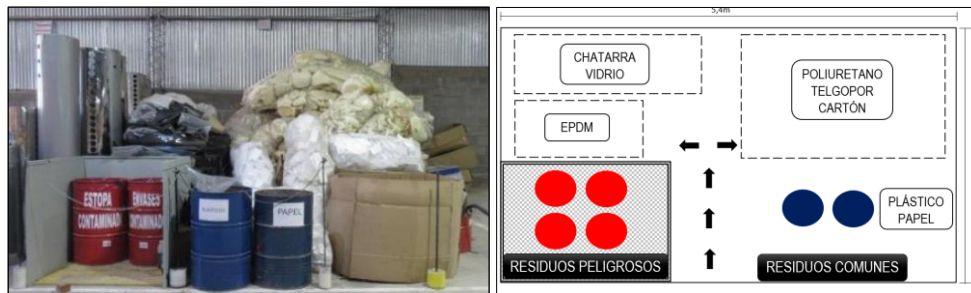
Imagen N° 10: Depósito transitorio de residuos con su croquis correspondiente. Fuente: Sungreen.
