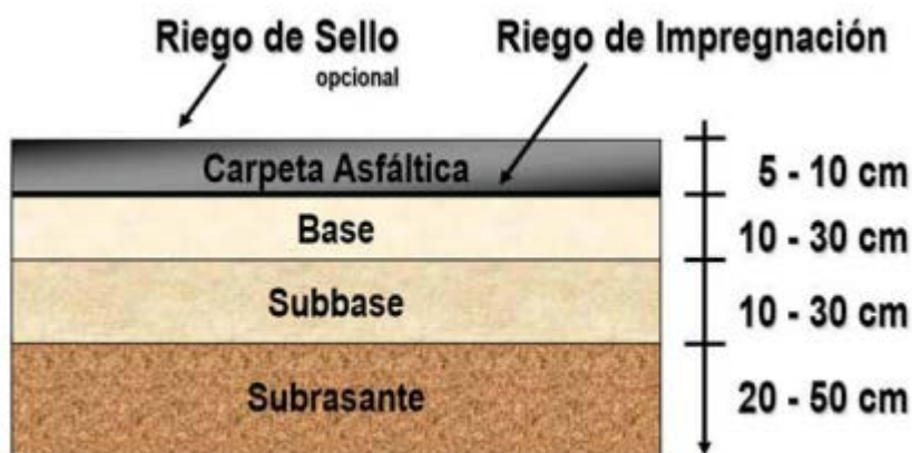
Ilustración XI. Estructura típica de un pavimento flexible
