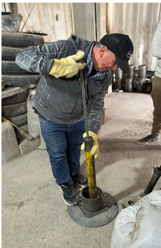
Ilustracion XL. Ensayo VN - E5 – 93 Compactación de suelo.
