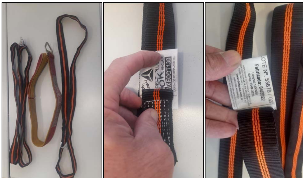
Figuras 26, 27 y 28: Elementos de amarre de conexión para PAE
