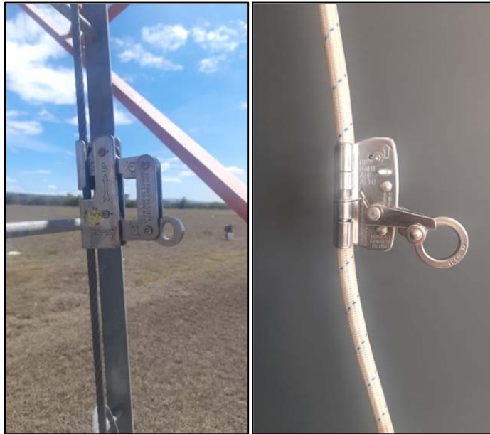
Figura 19 y 20: Salvacaídas colocados en cable y cuerda respectivamente.
