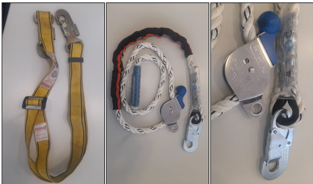
Figuras 23, 24 y 25: Elementos de amarre de sujeción o eslingas de posicionamiento
