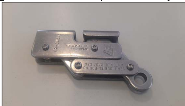
Figura 18: Salvacaídas deslizables para cable de acero de 8 mm
