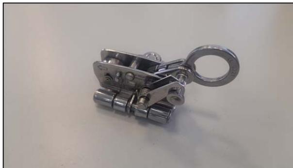
Figura 17: Salvacaídas deslizables para Cuerda de nylon de 10 mm
