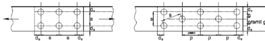
Figura J.3.1. Separación entre centros de agujeros.
