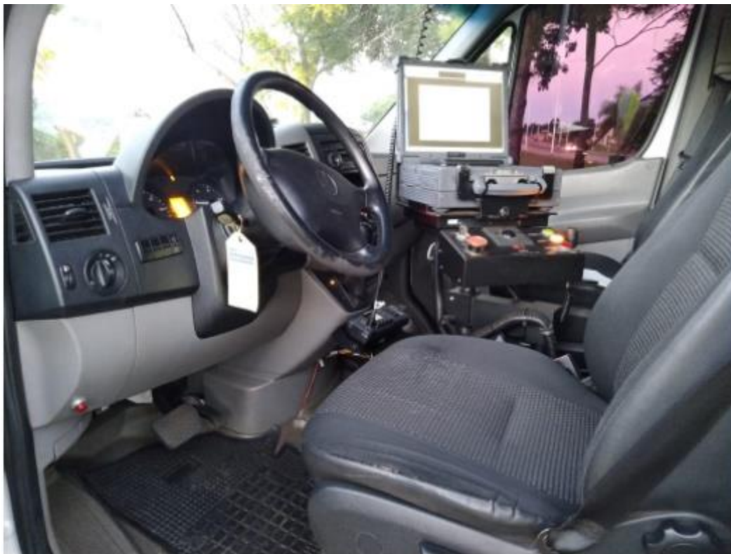
Figura 40. Vista Interior del Scanner Móvil donde se aprecia la computadora interna del equipo de Rayos X
