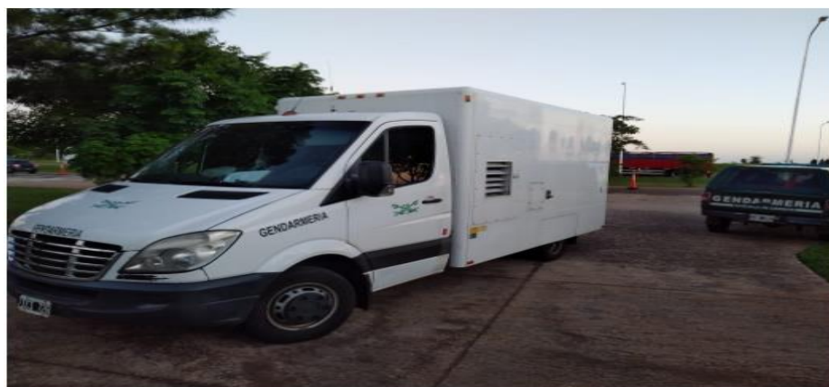
Figura 39. Scanner Móvil utilizado para el control de Camiones y Transportes de Carga
